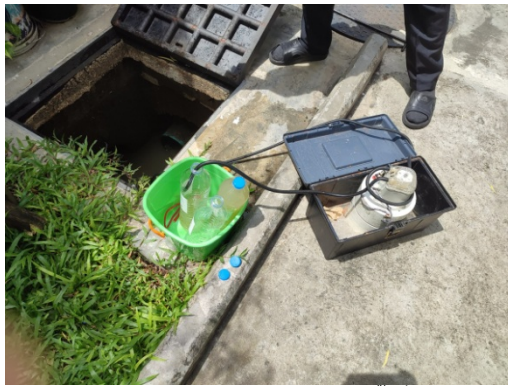
จุดเก็บตัวอย่างน้ำที่บ่อตรวจคุณภาพน้ำทิ้ง โดย Sampling Pump
